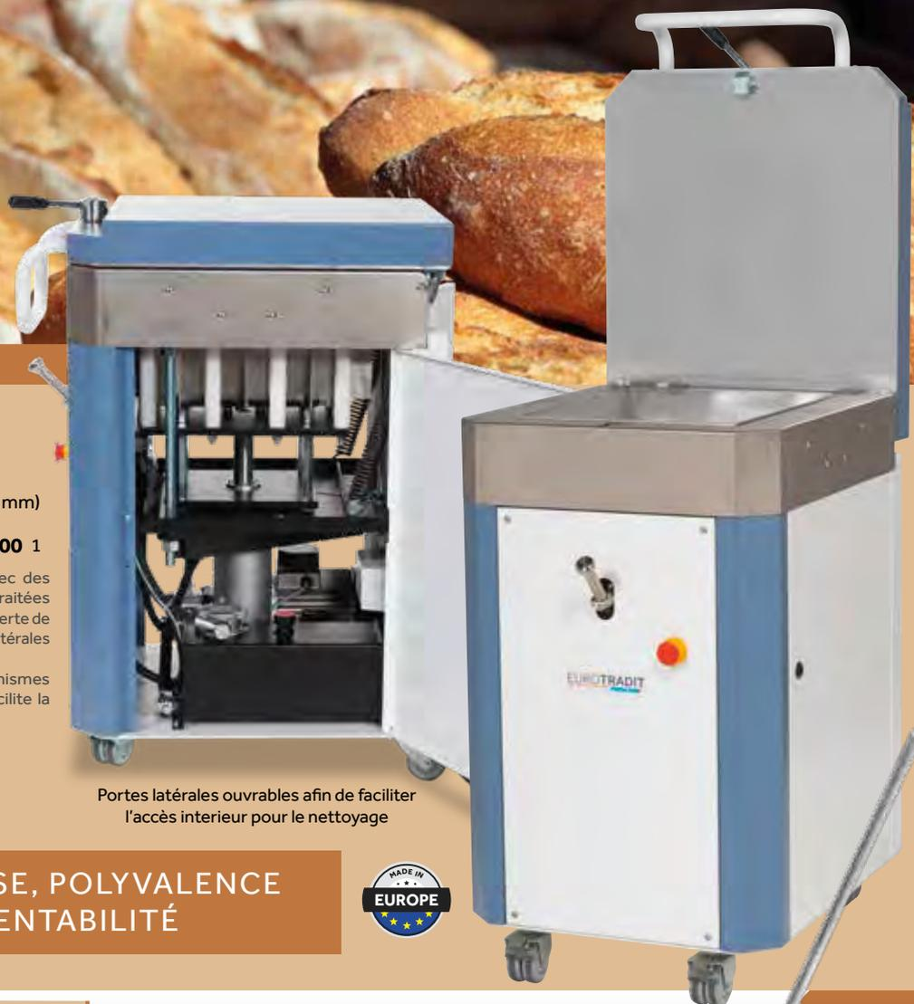
Portes latérales ouvrables afin de faciliter l'accès intérieur pour le nettoyage
